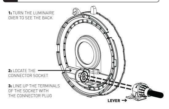
**4:** SLIDE THE CONNECTOR PLUG FIRMLY INTO THE SOCKET WITH THE LEVER HORIZONTAL
